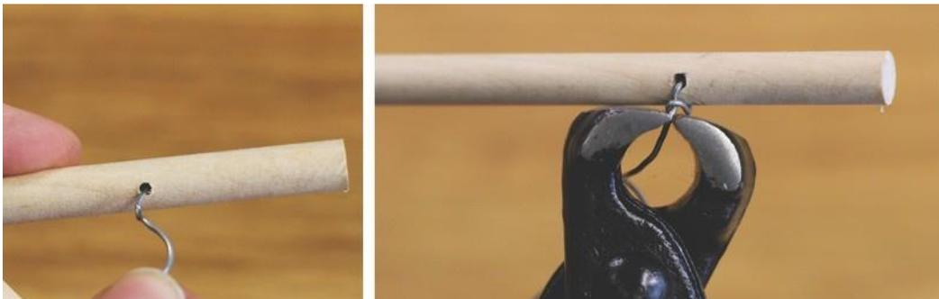
*Tipp: Desto stärker der Draht verdreht wird, umso stabiler wird die Halterung für die Flügel des Windrades.*
